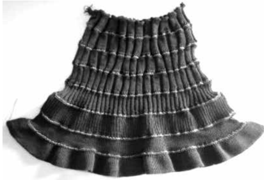
شکل ۴: برگزاری ساختارهای برش خورده با سایزهای مختلف برش با همان تعداد سوزن بافندگی ساخته شده است
